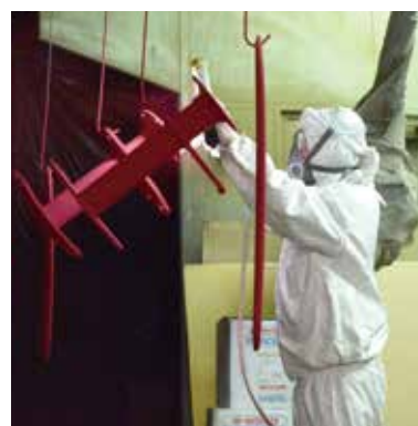
手作業で行う吹き付け塗装は、熟練工のなせる技。美しい塗装面が求められる高級なものほど人の手を必要としています。
